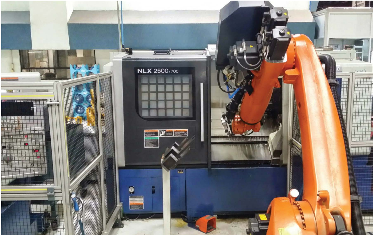
一個工作單元包含兩台車床、一台標記機、一個工件偵測器、機器手臂以及一套 Equator 檢具系統。
