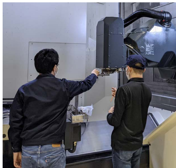
量測加工中心的精度
