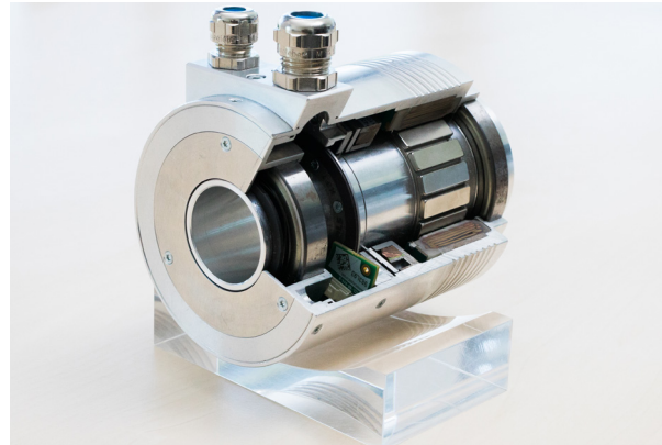
搭載 AksIM™ 絕對式磁性編碼器的 TQ-RoboDrive 空心軸伺服馬達的剖面圖
