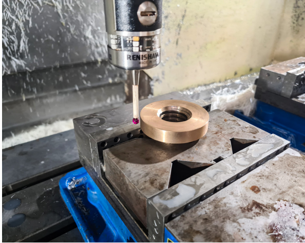
使用 Renishaw OMP40-2 光學傳輸測頭執行工件設定和檢測
