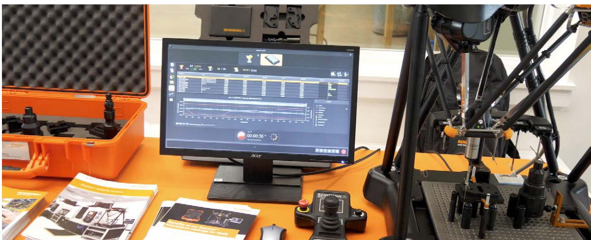
Renishaw 針對 NIMS 認證提供的 Equator 檢具系統套裝包括：預編程式、測針、兩塊量測夾具板，以及用於裝夾所有 13 種零件的夾具
