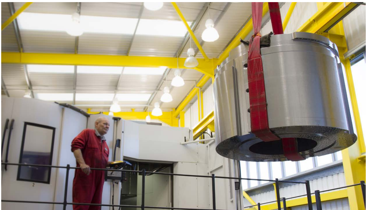
Intoco 使用 Mazak INTEGREX e-1850V 對更大直徑的部件加工
