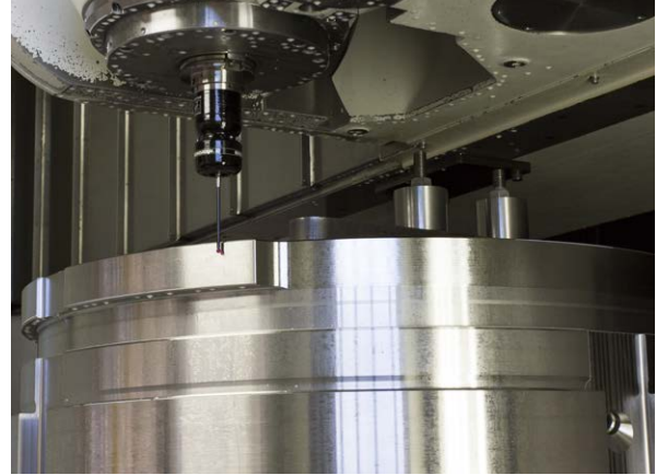
Intoco 使用 Renishaw 測頭系統量測製程中的大型部件
