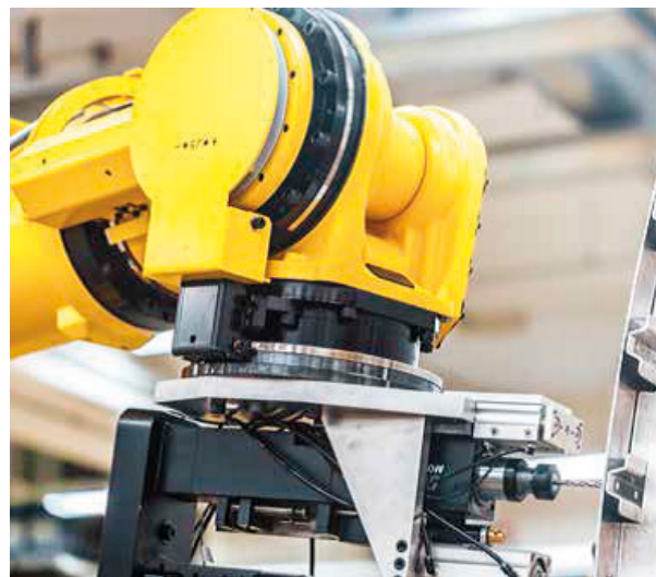
RESOLUTE 絕對式編碼器安裝在FANUC機械手臂的旋轉軸。 圖片版權歸FANUC所有。
