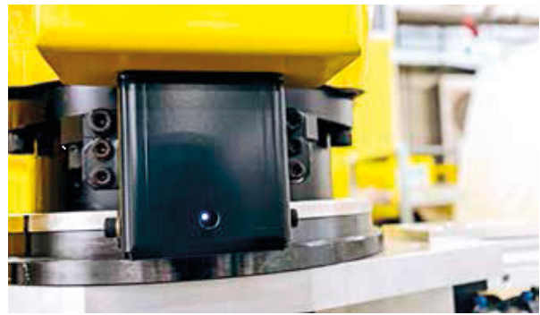
編碼器讀數上的安裝 LED 顯示編碼器的狀態。 圖片版權歸 FANUC 所有。
