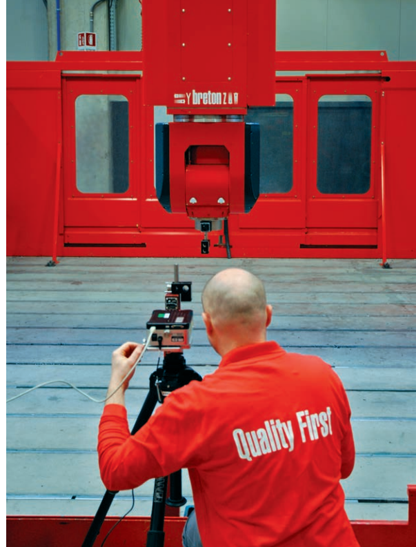
正在使用 XL-80 雷射干涉儀的 Breton 員工
