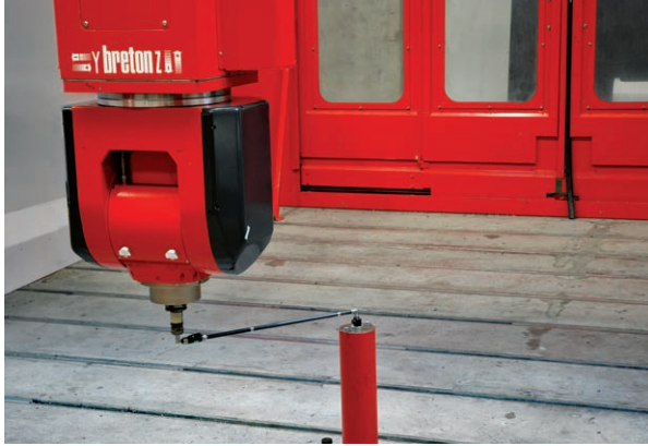
Breton 使用 Renishaw QC20-W 循圓測試儀檢查機械設備的定位效能
