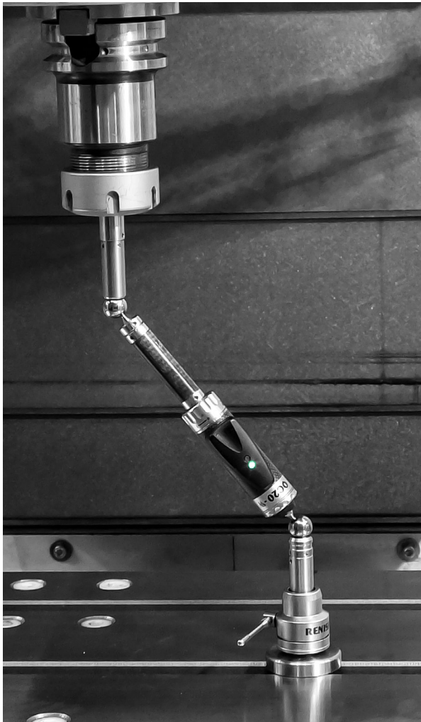
StankoMachComplex 使用 QC20-W 循環測試儀監測機台狀況
