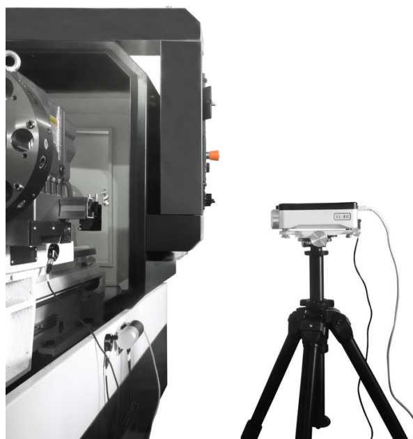
使用 XL-80 雷射干涉儀檢查工具機的移動精度
