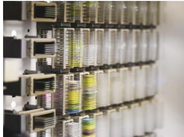
P1000 可容納 1,000 個玻片，在一次工作中將玻片全部數位化
