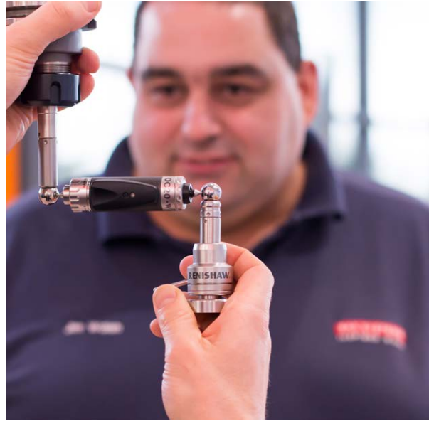
BAE Systems 員工 Jim Walsh 與 Renishaw QC20-W 循圓測試儀
