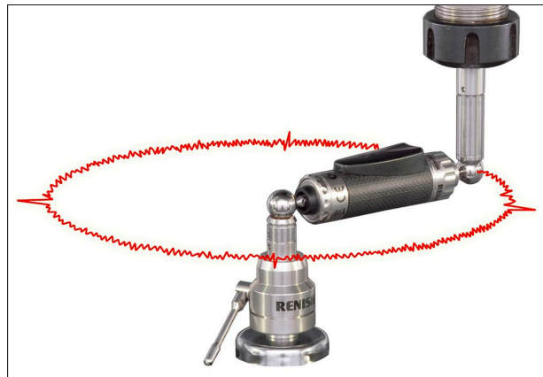
圖 4 — Renishaw QC20 循圓測試儀
