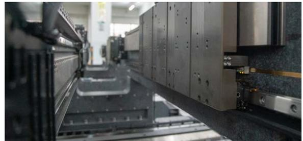
Renishaw RGSZ20S 鋼帶尺屬於「基材固定式」光學尺
