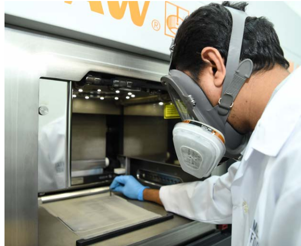
Renishaw 積層製造系統建構室
