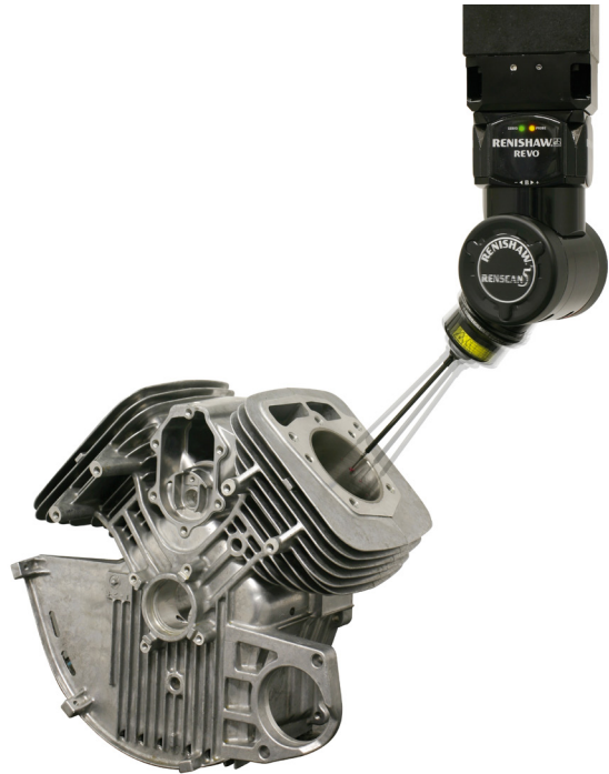
5-eksenli tarama teknolojisi CMM denetimini kökten değiştiriyor.
