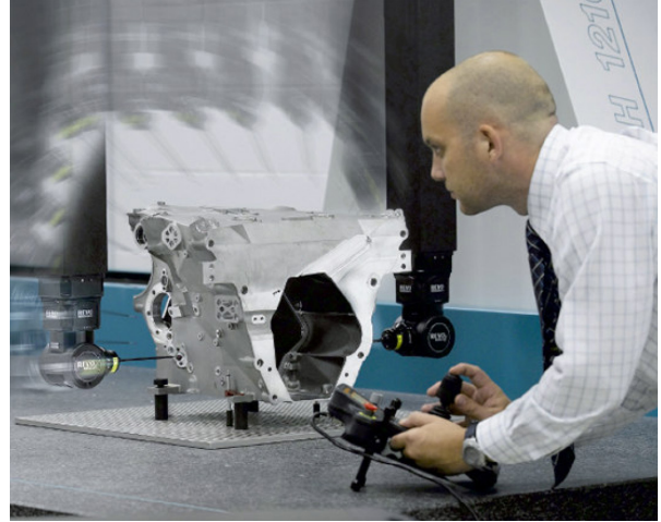
5-eksenli tarama karmaşık bileşenlerin, açı ayarı ve prob ucu değişimi için duraklama yapmadan, hızlı ve sorunsuz bir şekilde denetlenmesine imkan verir.
