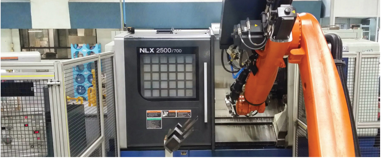
Bir çalışma hücresi iki torna tezgahı, bir işletleyici, bir parça cihaz dedektörü, robot ve Equator masterla parça kontrolü sisteminden oluşmaktadır.
