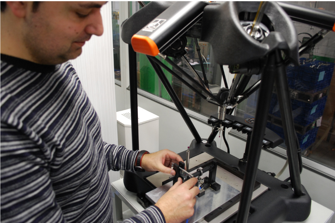
Bir Eponsa mühendisi master kontrol işlemi için hazır olan Equator'a bir silecek mekanizmasını yükliyor
