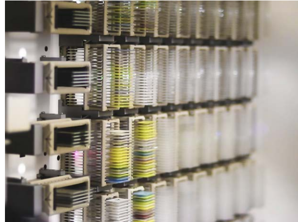
P1000 har kapacitet för 1000 objektglas och kan digitalisera dem alla under ett arbetsskift
