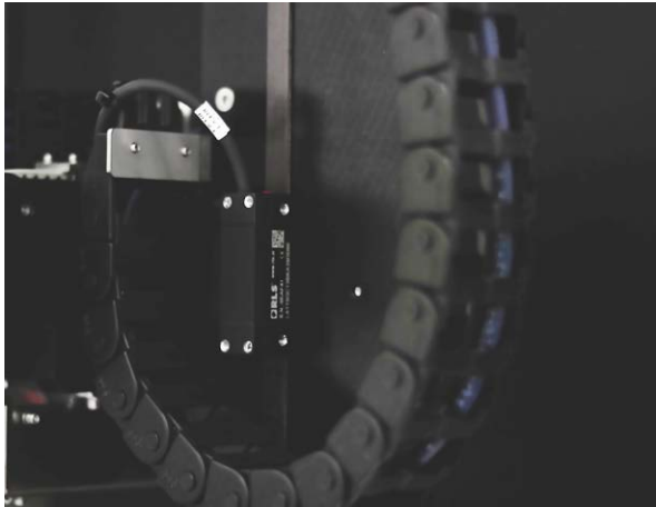
LA11 magnetisk kodare in situ på robotarmen
