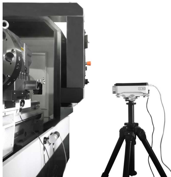
Kontrollera rörelsernas noggrannhet hos verktygsmaskiner med ett XL-80-lasersystem
