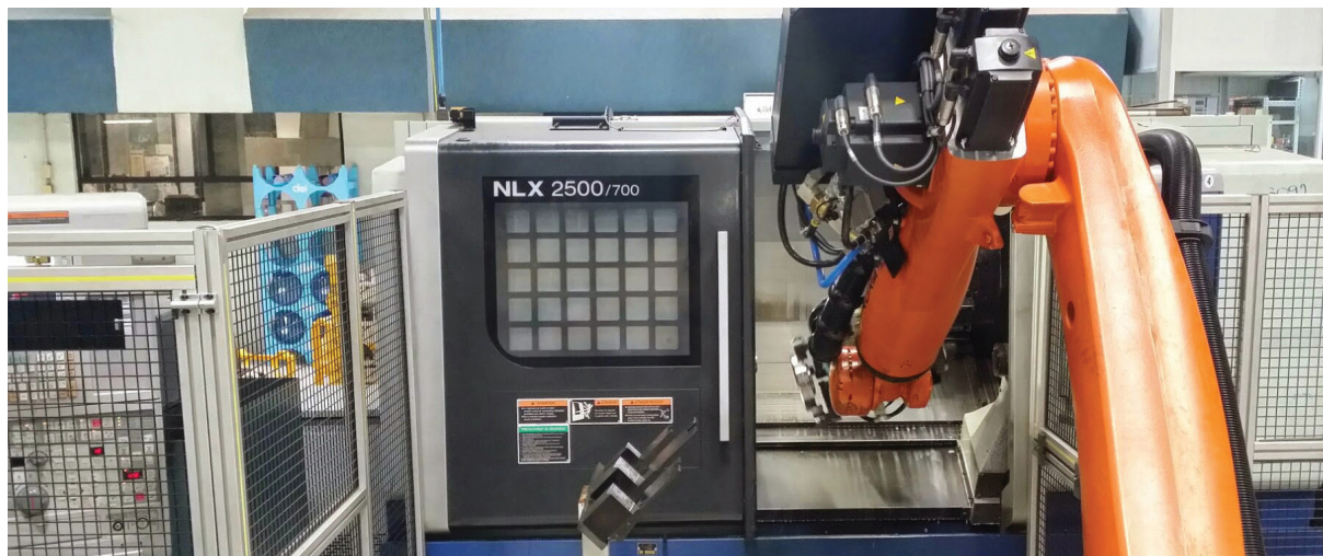
Obdelovalna celica vključuje dve stružnici, označevalno napravo, detektor delov, robota in merilni sistem Equator.
