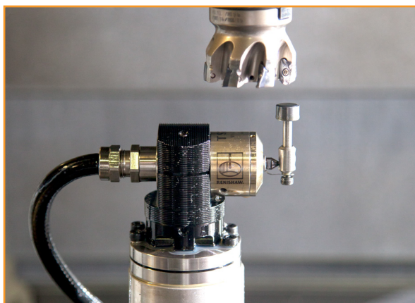
Samodejne meritve orodja s sistemom TS27R
