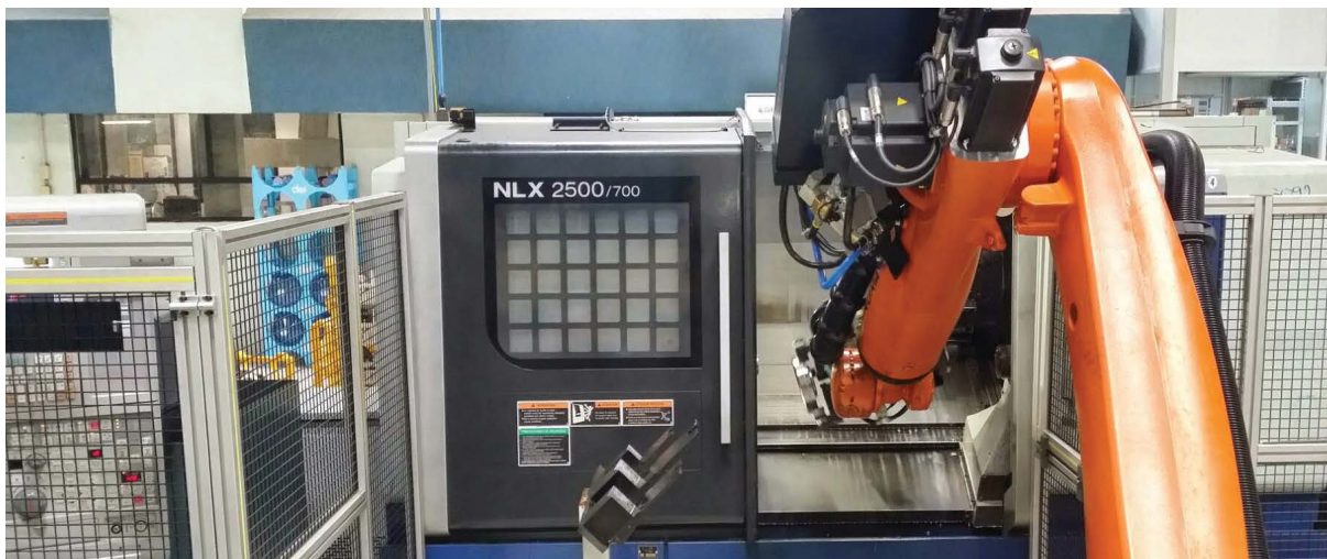
Автоматизированная производственная ячейка, включающая два токарных станка, маркировщик, детектор деталей, робот и универсальную систему цифровых шаблонов Equator.
