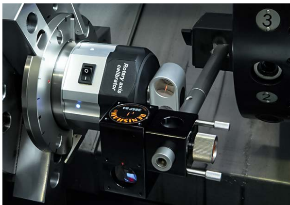
Калибратор поворотных осей XR20-W
