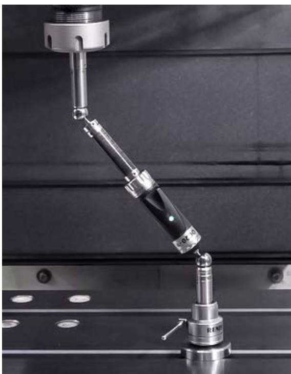
Система диагностики QC20-W ballbar
