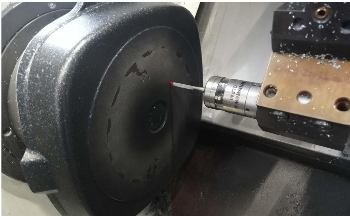
Датчик OLP40 определяет нулевую позицию перед обработкой
