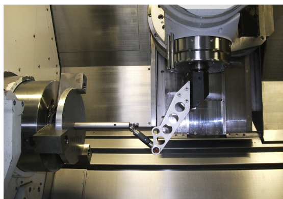
Выполнение проверки с помощью телескопической системы QC20-W ballbar на токарном станке с системой ЧПУ
