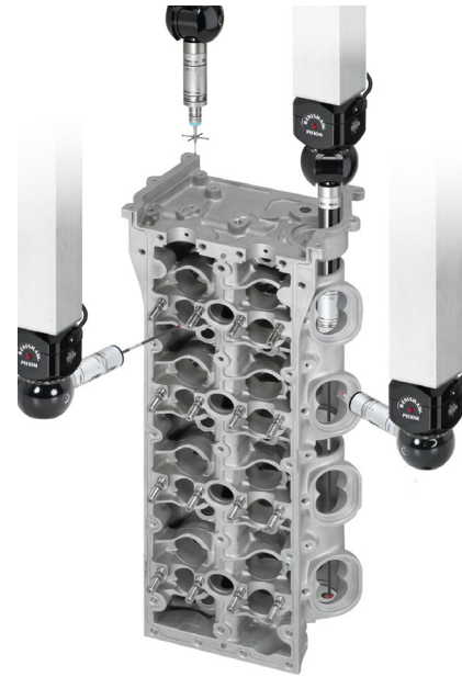
Рис.4 Гибкие в эксплуатации датчики модульной конструкции и головки с шаговым изменением угловых координат дают возможность расширить возможности измерений и повысить степень автоматизации благодаря обеспечению доступа ко всем элементам детали/узла после однократной настройки.
