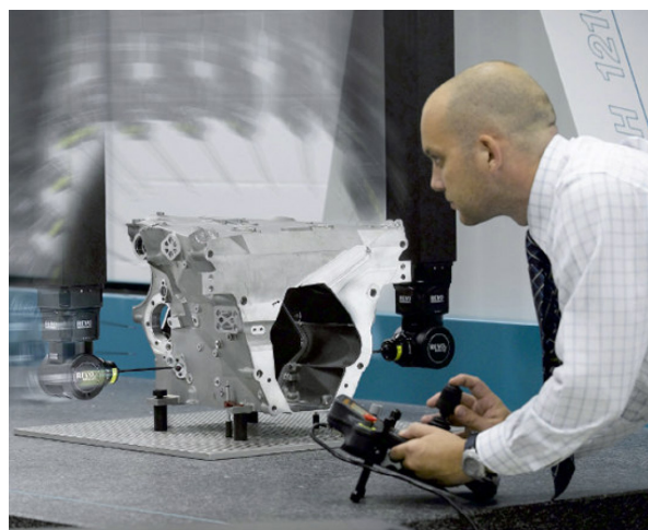
Рис.8 5-осевое сканирование обеспечивает быстрый комплексный контроль сложных компонентов, без остановок для шагового изменения углового положения головки и смены щупа.
