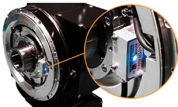
Рисунок 1. Поворотный энкодер RESOLUTE™ RESA от компании Renishaw, установленный на двигатель прямого привода (SOLPOWER, Тайвань)
