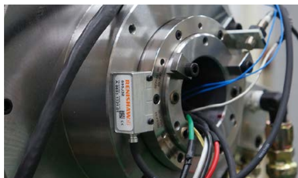
Рисунок 3. Использование поворотного стола DDR с установленным энкодером RESOLUTE (ITRI, Тайвань)
