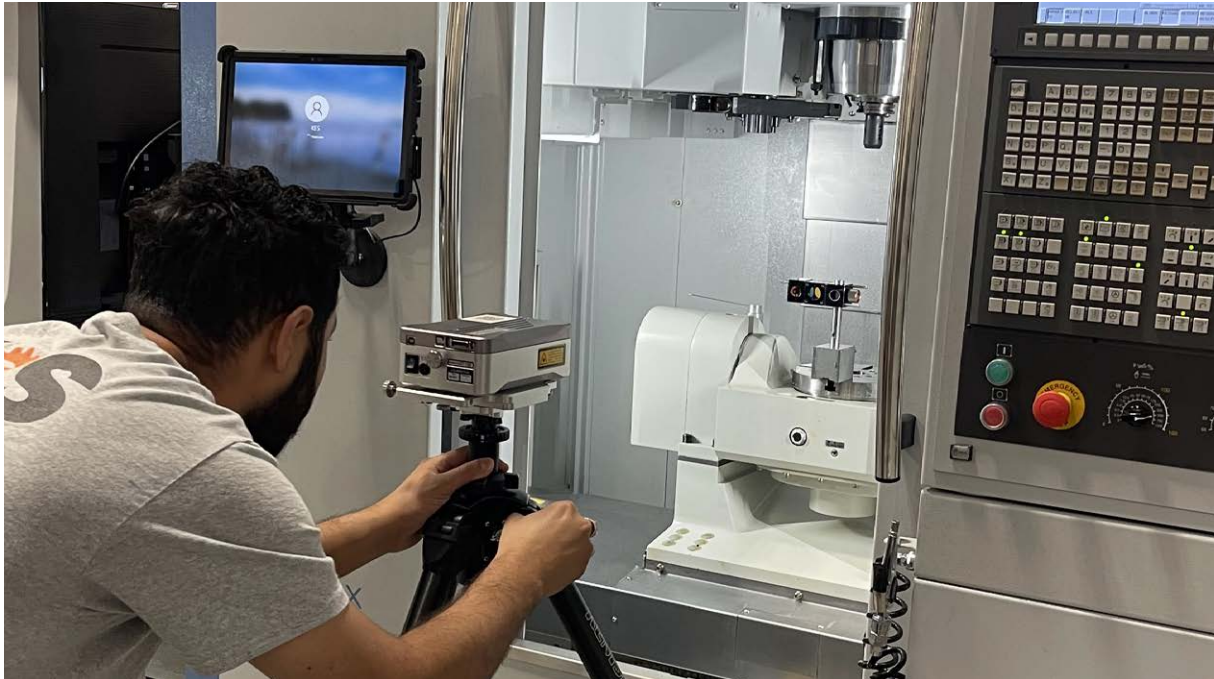
Sistema laser XL-80 da Renishaw em uma máquina-ferramenta CNC
