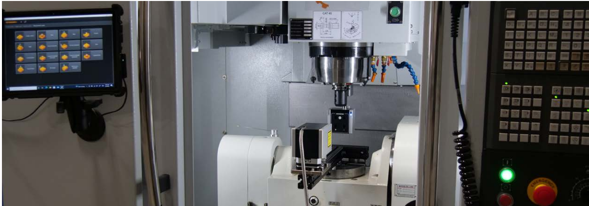
A KES usa o XM-60 em máquinas-ferramentas CNC e CMMs para realizar a compensação volumétrica.
