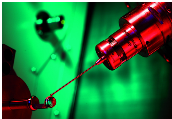
Ustalenie węzłów kinematycznych osi obrotowych wrzeciona na frezarko-tokarce
