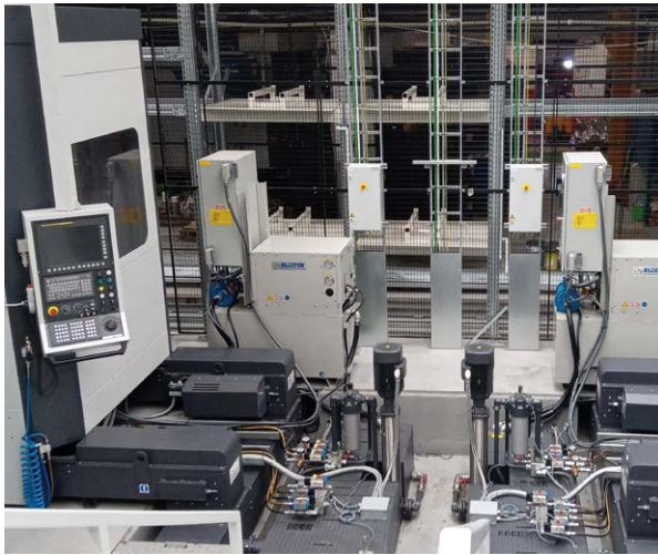
Maszyny Trevisan połączone w elastyczny system produkcyjny - FMS
