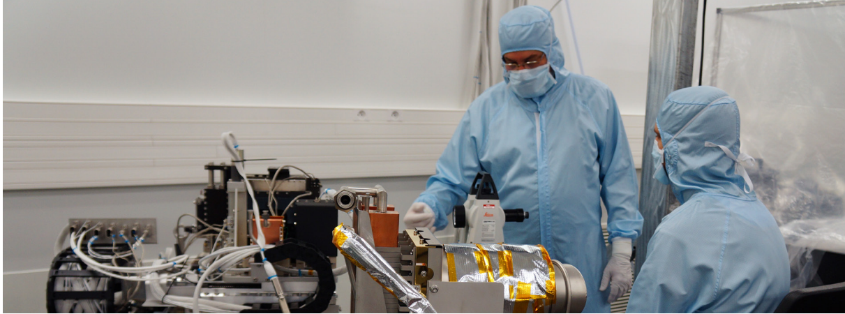
Roboty sześcioramiennie ZONDA do obsługi modułu IA DEA w warunkach wysokiej próżni
