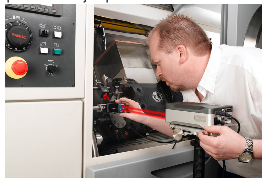
Een machine kalibreren met een laserinterferometer.
