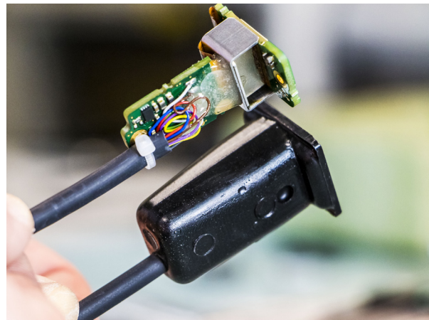
De RLS LinACE™ opnieuw verpakt in een waterdichte omkasting
