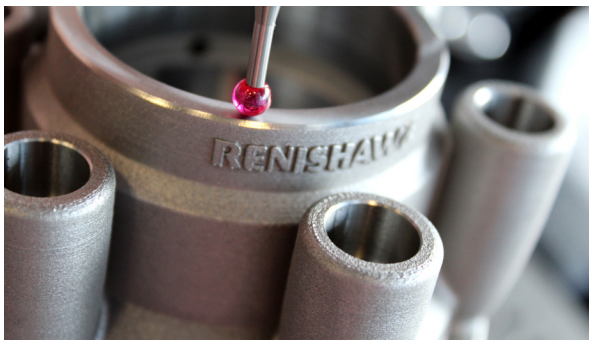
3D-metaalgeprinte hydraulische demonstratieverdeler voor Land Rover BAR
