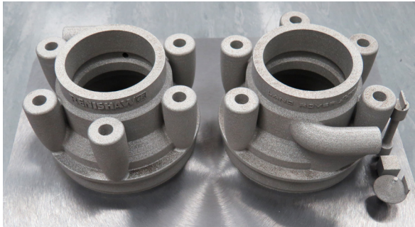
3D-metaalgeprinte demonstratieverdelers voor Land Rover BAR op de bouwplaat
