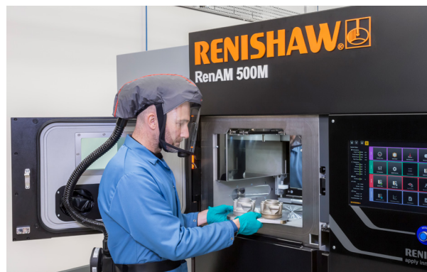
3D-metaalgeprinte demonstratieverdelers voor Land Rover BAR worden uit een Renishaw RenAM 500M systeem voor additieve productie in metaal genomen
