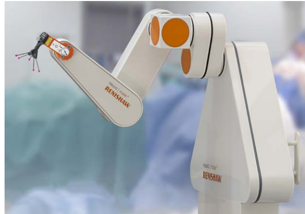
De neuromate stereotactische robot met de neurolocate module voor frame-loze patiëntregistratie
