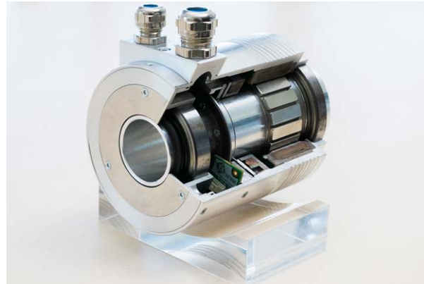
Opengewerkte TQ-RoboDrive servomotor met holle as en een AksIM™ magnetische absolute encoder.
