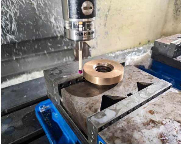
Producten instellen en inspecteren met de Renishaw OMP40-2 meettaster met optische transmissie
