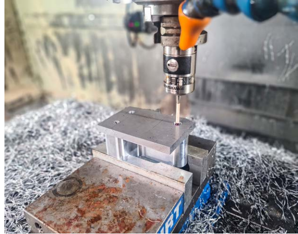
Producten instellen en inspecteren met de Renishaw OMP40-2 meettaster met optische transmissie
