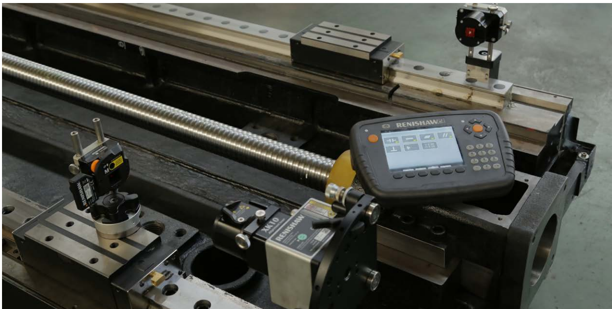
De XK10 in gebruik om de evenwijdigheid van twee geleiderails te meten
