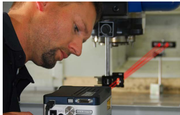
"Leds bovenop de XL-80 maken het instellen heel simpel; we kunnen de bundelsterkte in de gaten houden zonder steeds op de pc te kijken", aldus Jürgen Emslander
