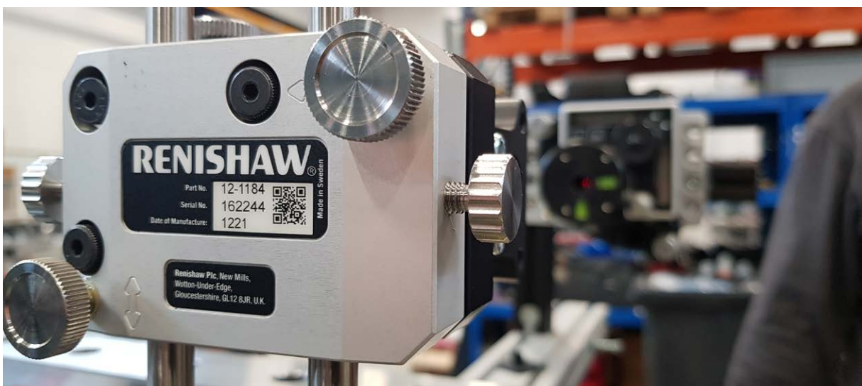
XK10 evenwijdigheidsset uitgelijnd op de machineassen
