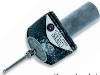
De eerste schakelende meettaster ter wereld
