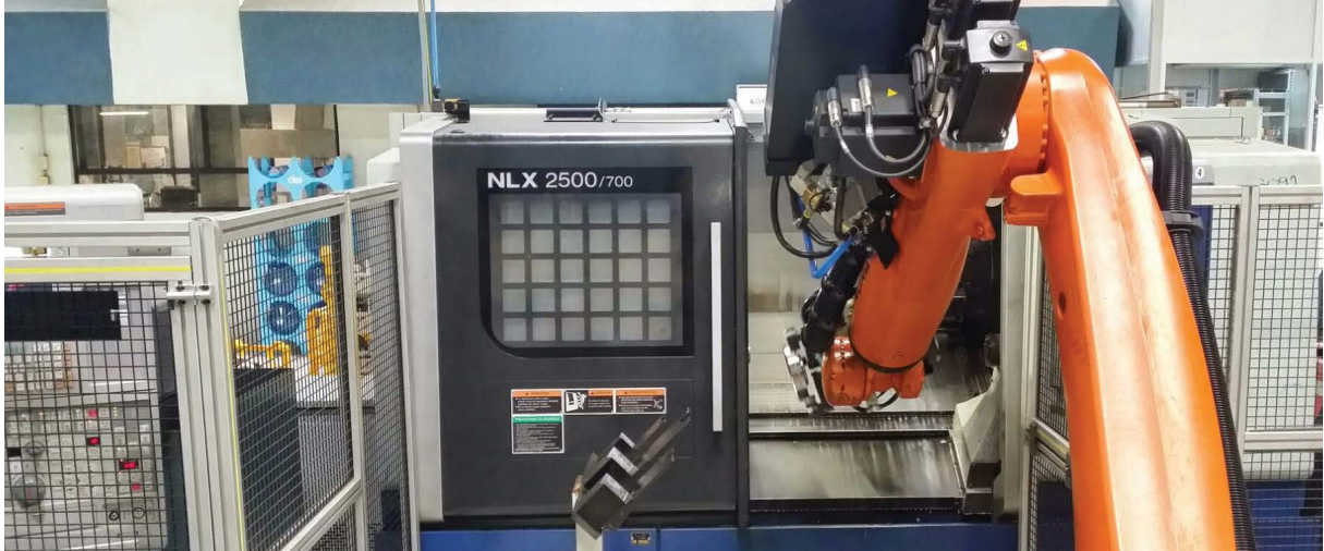
작업 셀은 2개의 선반, 마커, 부품 장치 탐지기, 로봇 및 Equator 측정 시스템으로 구성됩니다.
