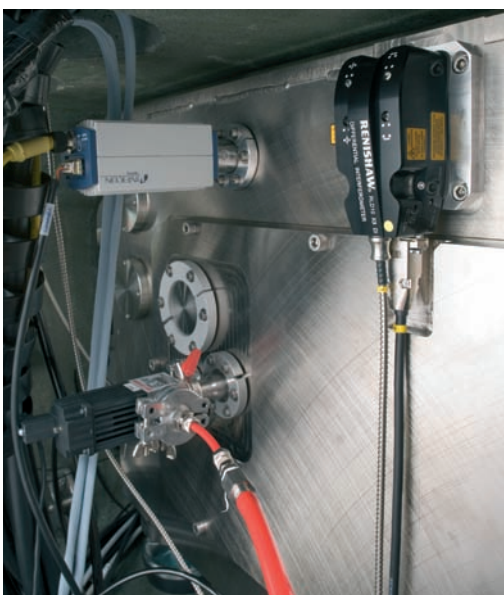
VB300 e-beam 컬럼과 스테이지 X-축 사이에서 측정하는 차동 간섭계, 분해능 77.2 피코미터
