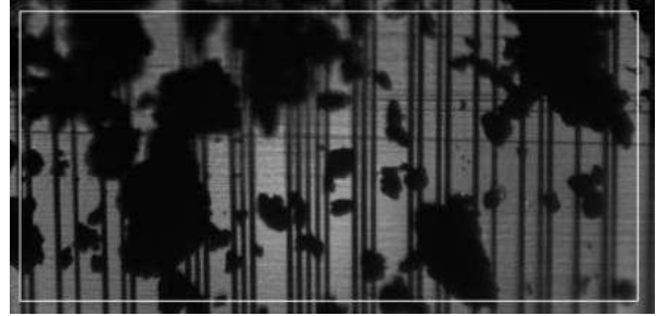
그림 1: 투명한 스케일 이미지와 스케일의 큰 영역을 가리는 입자 오염물질이 있는 스케일 이미지; 그러나 위상 정보는 여전히 판별할 수 있습니다
