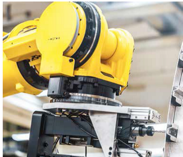
로터리 축에 RESOLUTE 절대형 로터리 엔코더가 있는 FANUC 로봇 암. 이미지 © FANUC.
