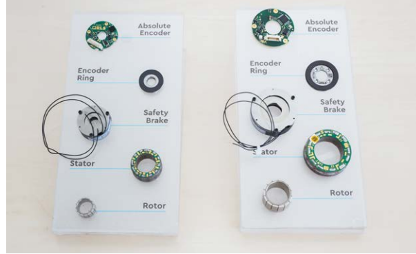
전시 중인 TQ-RoboDrive의 프레임리스 서보 키트 솔루션.
