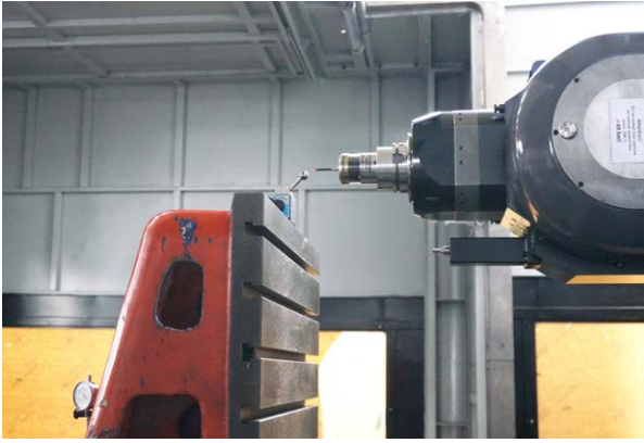
AxiSet Check-Up 로터리 축 검사 공구
