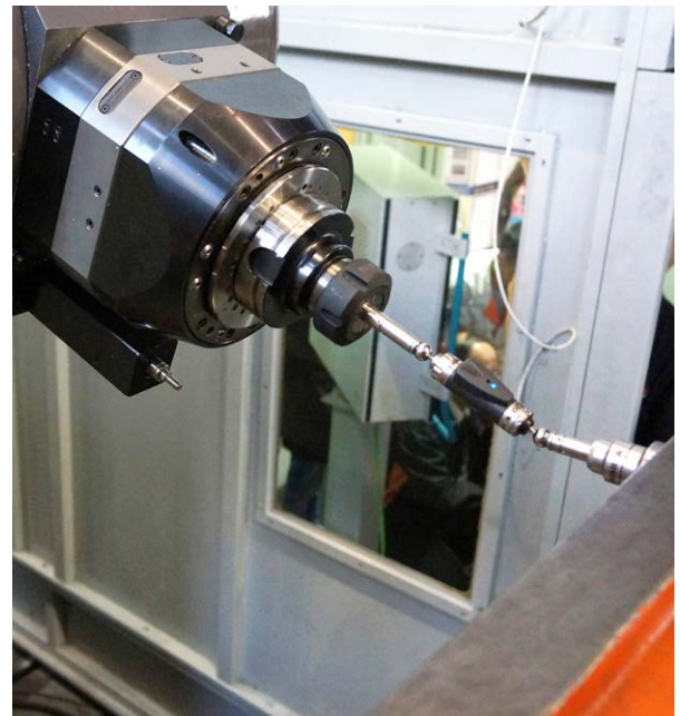
생산 현장에서 수행된 QC20-W 볼바 테스트
