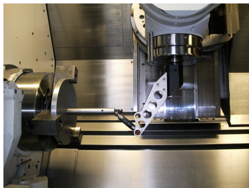
CNC 선반에서 테스트를 수행하는 QC20-W 망원 볼바
