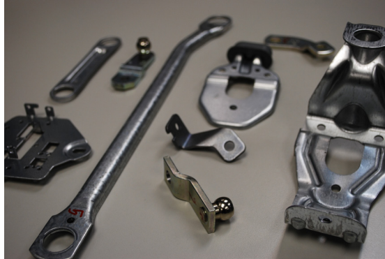
Eponsa는 윈드스크린 와이퍼 메커니즘을 위한 갖가지 찍어낸 부품을 생산합니다.
