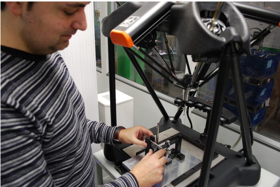
한 Eponsa 엔지니어가 측정 준비를 위해 와이퍼 메커니즘 부품을 Equator에 로드하고 있습니다
