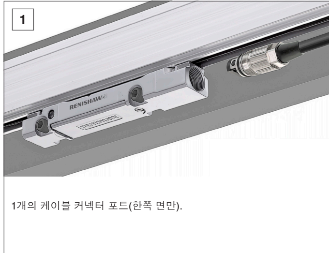
케이블을 판독 헤드에 삽입합니다. 올바른 커넥터 방향에 주의하십시오. 커넥터 키 에지가 판독 헤드 베이스를 향해야 합니다.
