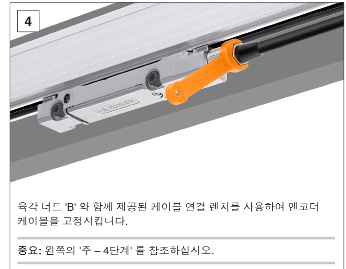
완전히 체결되면 위 그림과 같이 케이블 커넥터 그립 링이 판독 헤드 본체로부터 1 mm 떨어져 있어야 합니다.
