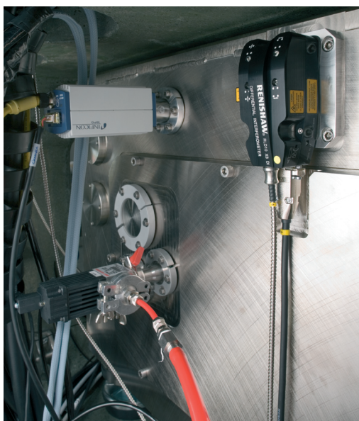
VB300 電子ビームコラムとステージの X 軸間を計測するディファレンシャル干渉計 (分解能 77.2 ピコメートル)
